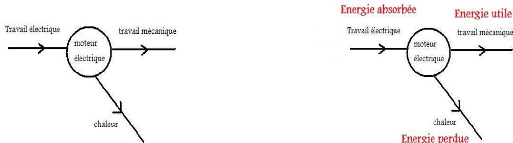
Pour un convertisseur d'énergie, Le rapport (énergie utile) / (énergie absorbée) se note  $\eta$  et s'appelle rendement
