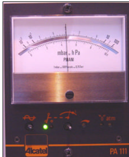
Figure 44 - Mesure du vide à l'aide d'une jauge PIRANI
